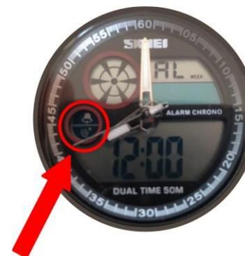
Za nastavitev časa alarma pritisnite **gumb C** (v načinu alarma). Pritisnite **gumb D**, da nastavite uro, nato pritisnite **gumb C** za potrditev in nastavitev minut z **gumbom D**. Za potrditev časa budilke pritisnite **gumb C**, dokler prikazani čas ne utripa.
